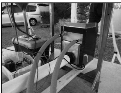
写真4 冷温水コイル
