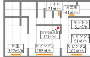
図 5 床下平面図および床下吹出風量・各床スリット目標風量
