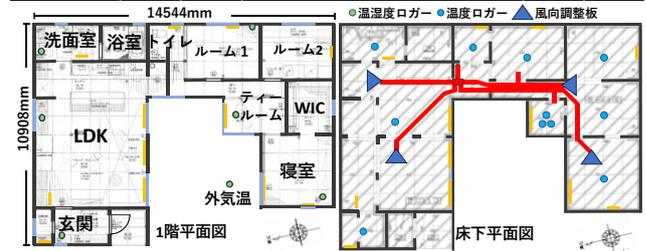
図6 平面図と計測点
