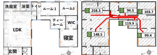
図11 風量測定結果
