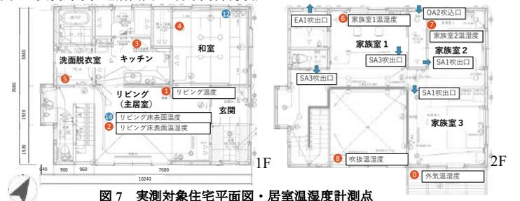
図7 実測対象住宅平面図・居室温度計測点
