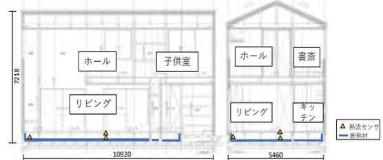
図2：断面図および計測点概要 (b邸)
