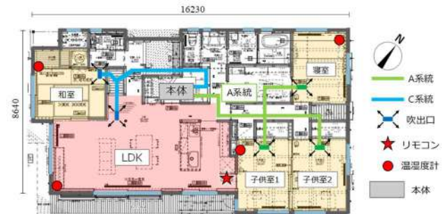
図4: a邸の平面図とダクト経路
