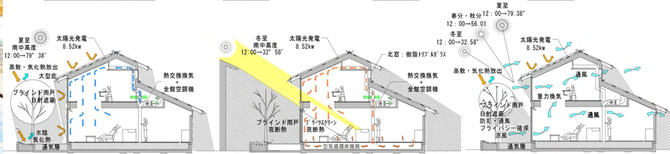
夏/遮熱+冷房 冬 昼/窓集熱+床暖房 夜/断熱+暖房 春・秋/防犯+通風/除湿+循環
