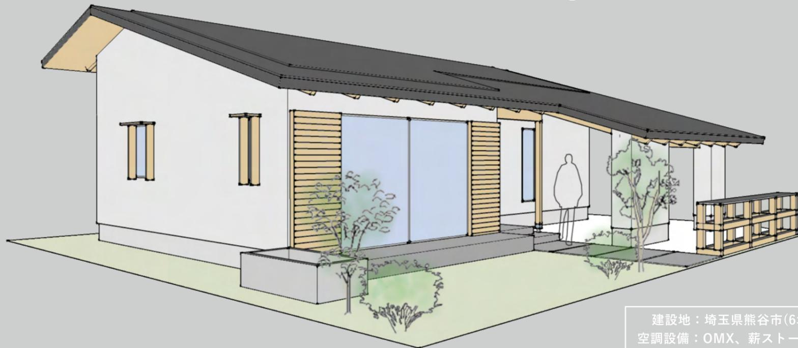
埼玉県熊谷市に40代夫婦、二人暮らしのための平屋を設計する。太陽や自然のエネルギーを利用し、一次エネルギー消費量を抑えたパッシブデザインの住宅を計画した。空調にはOMXを採用。さらに、ダイレクトゲインを利用することで太陽熱、太陽光を余すことなく暮らしに取り入れる。自然通風、自然換気、雨水利用など、自然とともに暮らす住宅をコンセプトとした。
