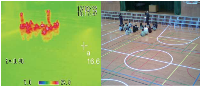
OMソーラー導入の川崎市立久末小学校体育館の温熱画像 (3月22日10時 床温16.6℃、外気温11℃)
